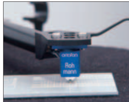
Der Nadelträger ist die Bezugslinie für die Grundjustage. Er sollte mit der Mittellinie fluchten.
